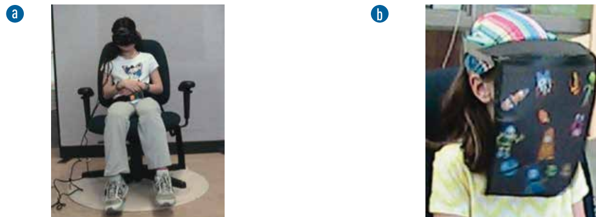
FIGURE 3 : Photo d'un enfant lors du test m-ECVCT. L'enfant était assis sur le fauteuil rotatif, les yeux fermés, retenu par une ceinture de sécurité. Le fauteuil tournait pendant 30 s à une fréquence de 0,5 Hz. Une fois la rotation terminée, la durée du nystagmus post-rotatoire était calculée alors que l'enfant portait des lunettes de vision nocturne (photo a). Note : Le test peut être effectué autrement, par exemple au moyen d'un écran prévenant la fixation du regard. L'examineur enregistre alors le NPR en regardant par le côté (photo b).
